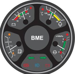
Прибор комбинированный КД8802 предназначен для контроля следующих параметров погрузчика:
