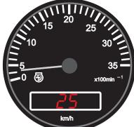
Блок эксплуатационных параметров (тахоспидометр) БЭП-2 предназначен для контроля следующих параметров погрузчика:
