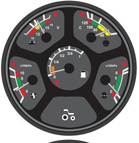
Прибор комбинированный КД8811 предназначен для контроля следующих параметров трактора:
